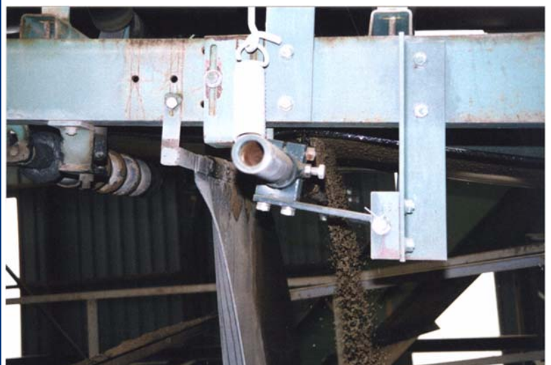
KS Ausführung (federbelastete)
